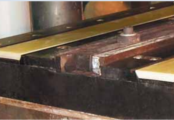
模压成型和加工成型的槽楔在高温下能耐受极大的压力。
