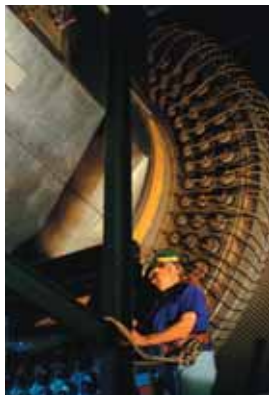
垫块材料用于固定和分隔发电机铜绕组。
